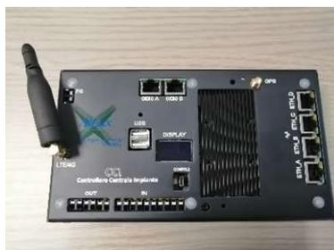
Il CCI è un Gateway per il monitoraggio di impianti di Produzione, prescritto da ARERA con delibera 36/2020/R/EEL e descritto dalla norma CEI 0-16 V1 del 2020 e V2 del 2021 negli allegati O e T, la sua funzione è quella di raccogliere le informazioni dall'impianto e di trasmetterle in modo sicuro al Distributore (DSO) o ad altro Operatore abilitato.
